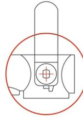
Cuando el mango es girado **hacia arriba**, el conjunto de válvula reductora de presión está en el estado **abierto** a la reductora de presión.
