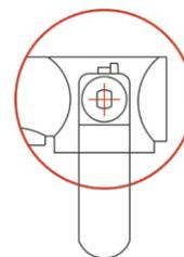
Cuando el mango es girado **hacia abajo**, el conjunto de válvula reductora de presión está en el estado **cerrado**.
