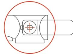
Cuando el mango es girado queda en **paralelo** a la tubería, el desvío del conjunto de válvula reductora de presión está el estado **By-pass**.
